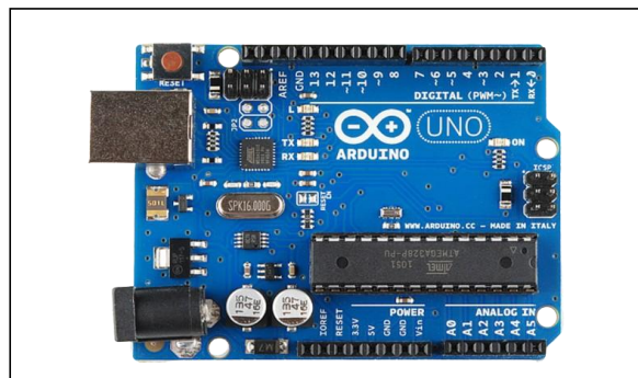
Figure 4: Arduino Uno R3
